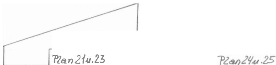
Wie den Skizzen zu entnehmen ist, sieht der Plan 21 und 23 eine Abtreppung der Fundamentunterkante, jedoch eine schräg verlaufende Oberkante vor. Hingegen weist der Plan 24 und 25 auch eine Abtreppung der Fundamentoberkante auf. Die Abrechnung der Fundamente und der darüberliegenden Wände erfolgte auf Basis der Pläne 21 und 23.
